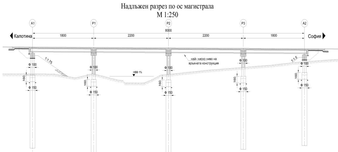
Фигура 5: Надлъжен разрез на моста над р. Църна бара при км 44+340 от АМ „Европа“
